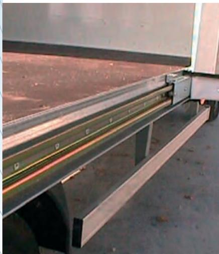
Profilo in acciaio inf. da avvitare sul pianale
